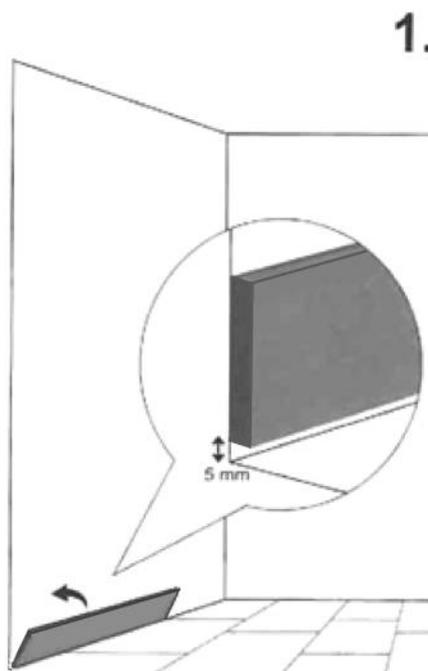
1. Avant de vous lancer, présentez la lame au mur, sans retirer le film protecteur mais en respectant entre celle-ci et le sol un **joint de dilataion de 5 mm**. Tracez des repères si besoin (avec le niveau à bulle), cela vous aidera à bien positionner vos lames horizontalement.
