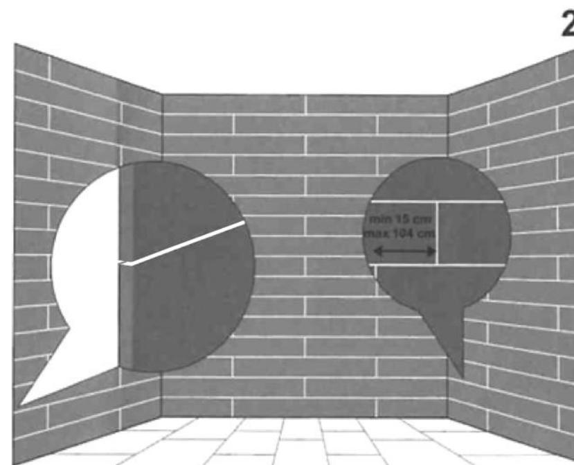
3. La chute vous servira pour démarrer la rangée suivante. N'hésitez pas à présenter la lame coupée avant d'en ôter le papier protecteur. D'un rang à l'autre, les joints doivent être décalés d'au moins 15 centimètres. La pose des lames du rang suivant s'opère en les amenant au bord de celles déjà en place mais en laissant un jeu de dilataion d'au moins 0.5 m. N'hésitez pas à vous exercer avant de retirer le papier protecteur.
